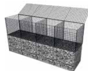
Tweede rij schanskorven verbinden met binddraad
