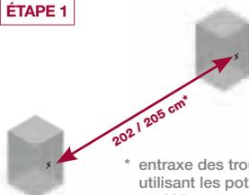
\* entraxe des trous : 202 cm en utilisant les poteaux Bekaclip® ou 205 cm en utilisant les poteaux Bekafor® Click.
